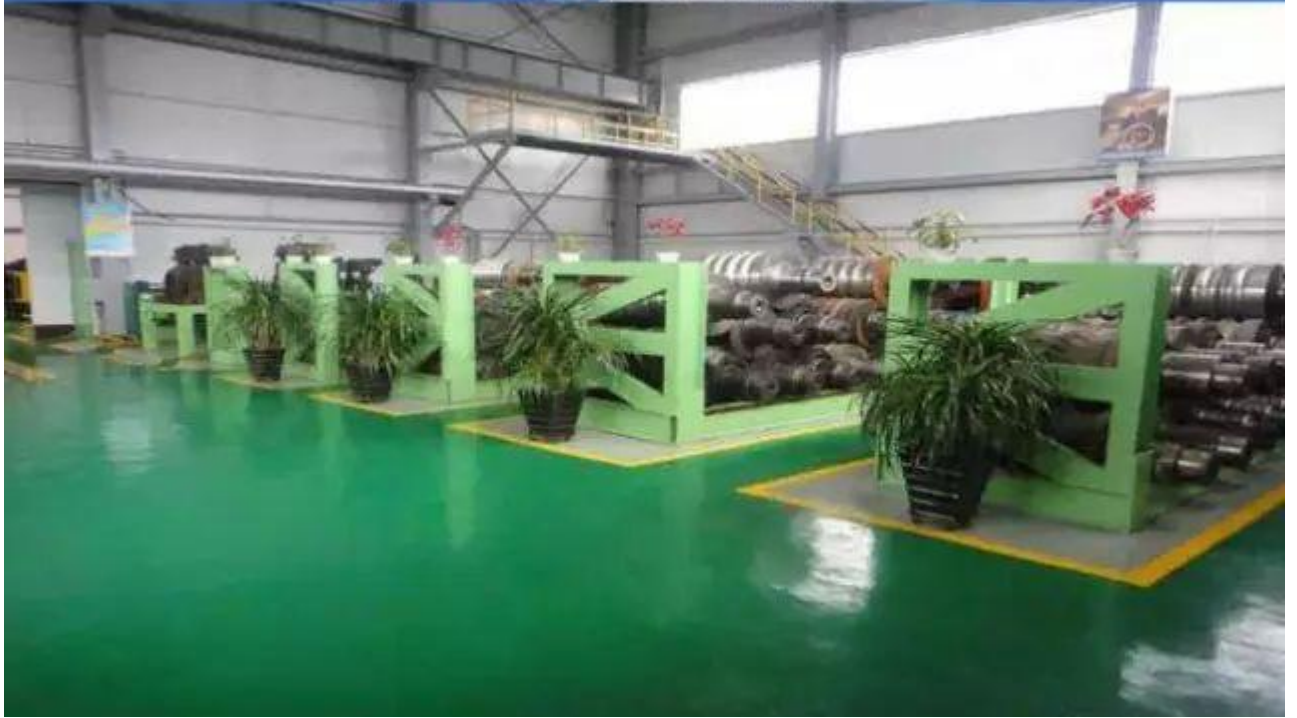
棒材厂轧辊车间轧辊存放区
